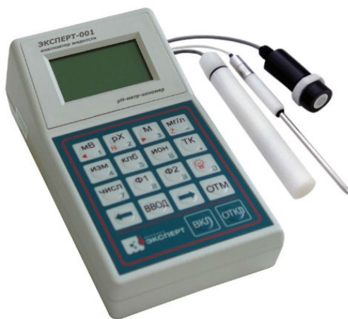
Рис. 3. Портативное устройство для определения в воде pH, биологического потребления кислорода, температуры и содержания растворенного кислорода ( https://ionomer.ru/ )
